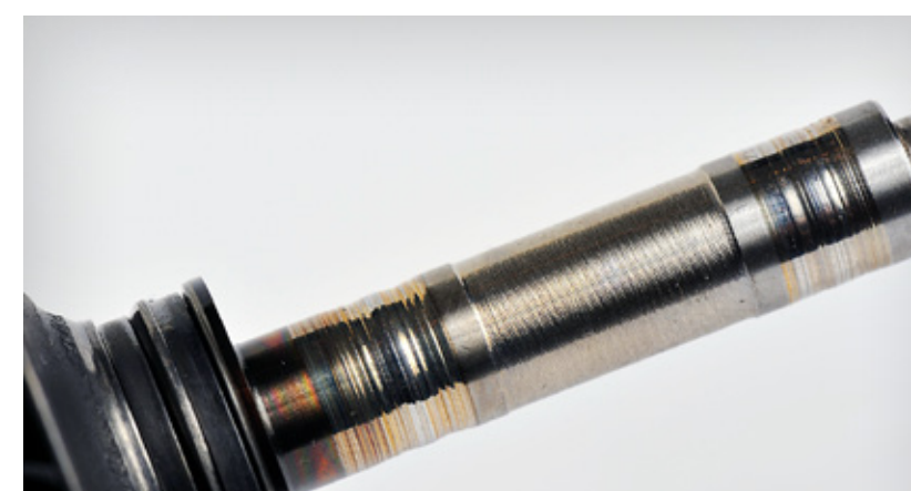
Apoyo desgastado y rayado, con transferencia de materiales en el eje
