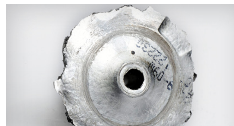
El efecto de piel de naranja en la parte posterior de la rueda del compresor es un signo claro de sobrevelocidad
