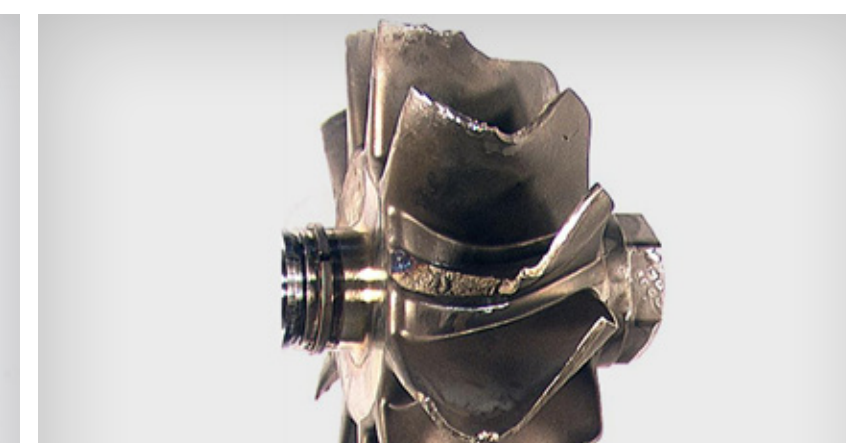
Rueda de la turbina con rotura por fatiga causada por sobrevelocidad repetida
