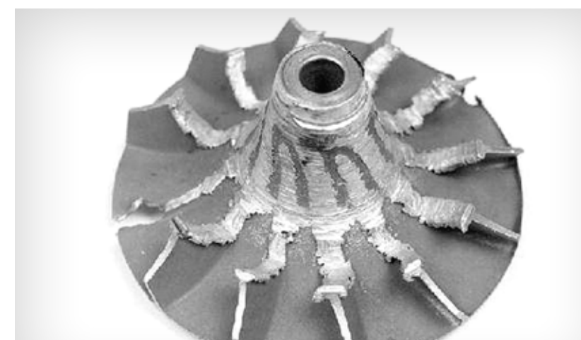
Rueda del compresor deteriorada
