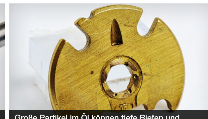
Große Partikel im Öl können tiefe Riefen und Beschädigungen verursachen
