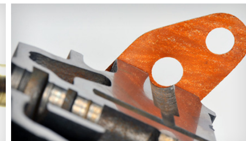
Falsche Form und Einbaulage der Dichtung
