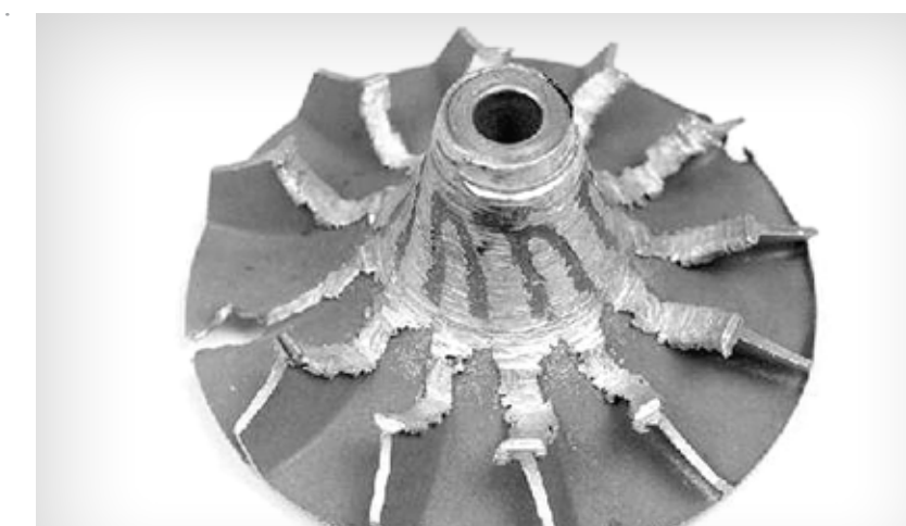
Schaden an einem Verdichterrad
