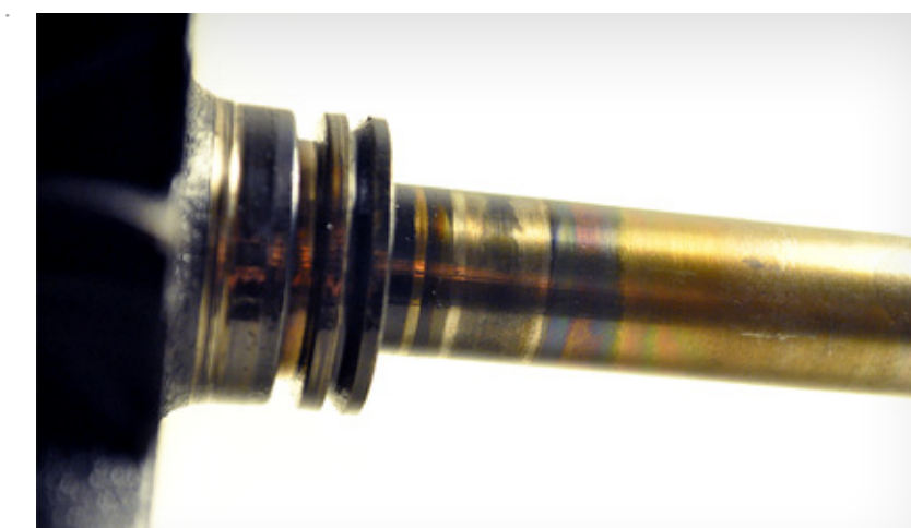
Überhitzung und Materialtransfer zum Lager
