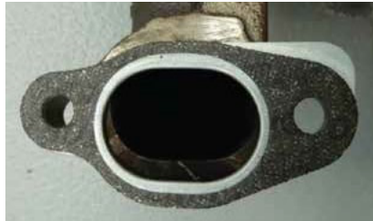
Nicht korrekte Montage
