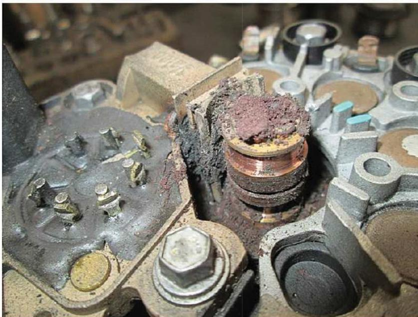
**Cet alternateur est positionné sur le véhicule à proximité d'une source de liquide gras (gasoil, liquide de frein...)**
