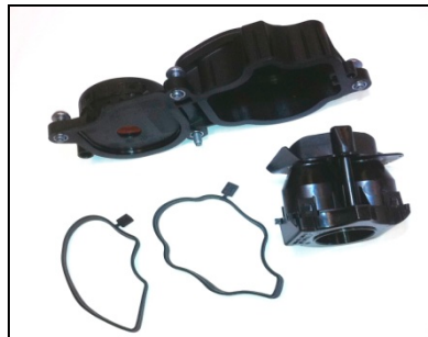
Unitate de ventilare modificată
