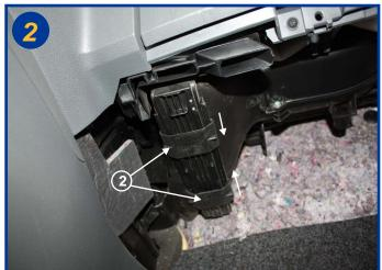
Faire coulisser les 2 bagues plastique (2) dans le sens des flèches et retirer le couvercle du boîtier filtrant.
