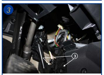
Presser sur les deux poignées prévues à cet effet pour retirer le couvercle du boîtier filtrant (3). Extraire l'élément filtrant usagé.
