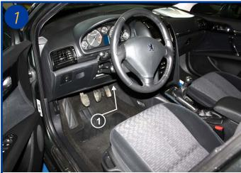
Le filtre d'habitacle est situé à l'intérieur du véhicule, coté conducteur à droite derrière la console centrale (1).
