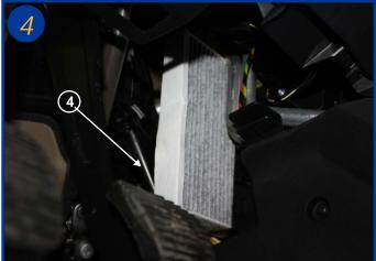
Procéder au remplacement de l'élément filtrant, afin d'avoir plus de facilité pour le mettre en place dans le boîtier, il est conseillé d'appuyer simultanément sur la pédale d'accélérateur (4). Le remontage s'effectue dans l'ordre inverse du démontage.
