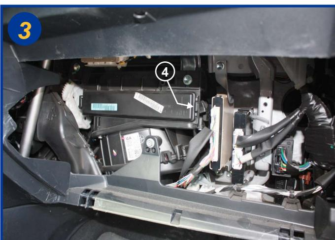
Ouvrir le boîtier filtrant du côté droit (4) et retirer le couvercle.
