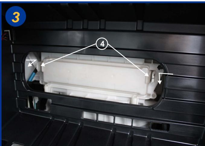
Ouvrir le boîtier filtrant en actionnant les tirettes dans le sens des flèches à gauche et à droite du couvercle (4).
