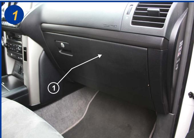
L 'élément filtrant est situé à l 'intérieur du véhicule, coté passager derrière la boîte à gants (1).
