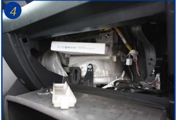
Extraire I 'élément filtrant usagé et le remplacer. Le remontage s 'effectue dans I 'ordre inverse du démontage.
