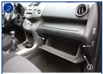
Ouvrir la boîte à gants, appuyer sur les fancs du tiroir afin de dégager les arrêtoirs (voir flèche) et retirer le vérin de retenue (2).
