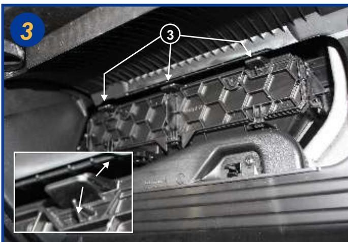
Ouvrir le boîtier filtrant en dégageant les 3 pattes (3), il suffit d'écarter les pattes (voir détail). Retirer le couvercle.
