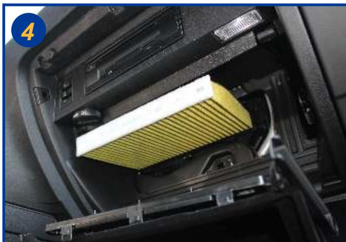
Retirer le filtre usagé et le remplacer. Le remontage s'effectue dans l'ordre inverse du démontage. Attention de bien replacer l'amortisseur de descente.
