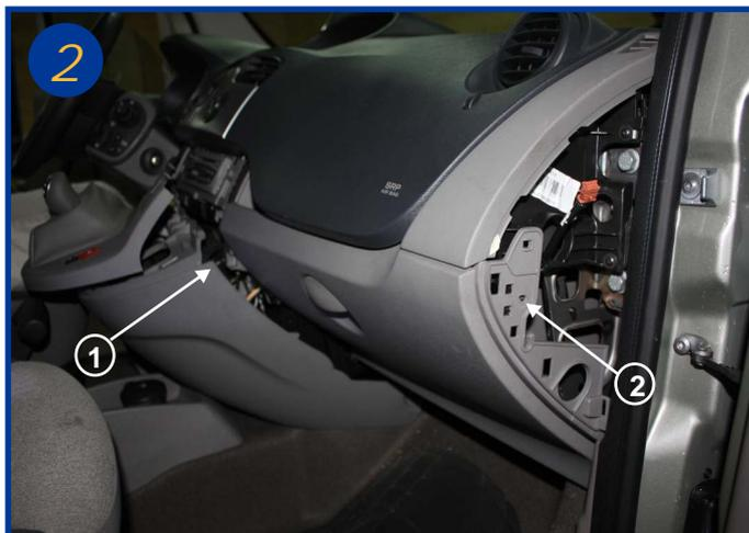
Dévisser les 2 vis Torx T20 situées devant la console sous l'auto-radio, désaccoupler la console centrale (1). Vêrrouiller l'air-bag et déconnecter le. Retirer le flanc de côté. Dévisser la vis Torx T20 (2)
