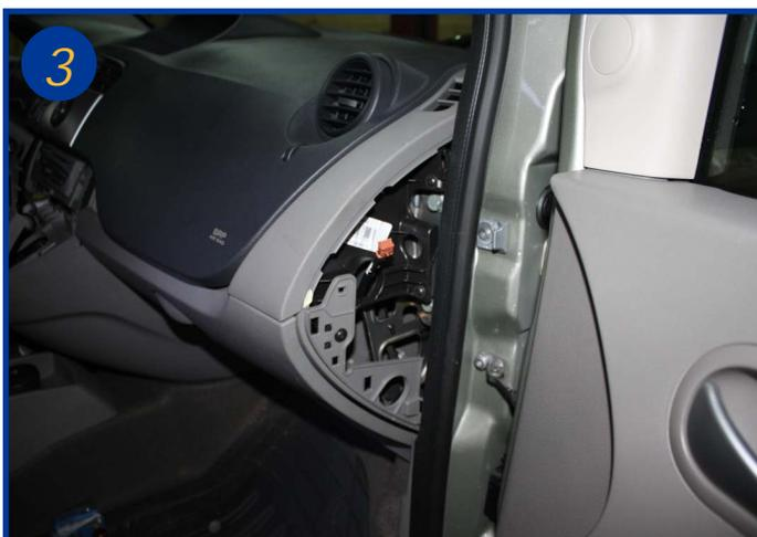
Ouvrir la boîte à gants et dévisser les 6 vis Torx T20 de fixation de la boîte à gants (2 sont situés devant la fermeture de porte, 2 près des charnières de boîte et 2 côté console). Sortir la boîte à gants dans sa totalité.
