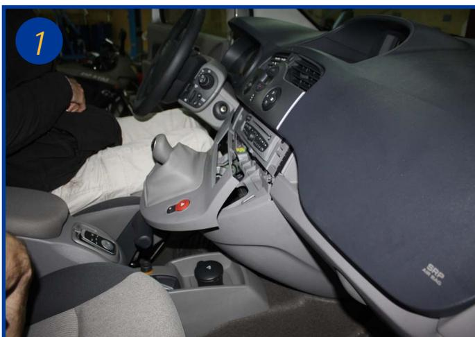
Le ou les filtres habitacles sont situés à l'intérieur du véhicule côté passager, derrière la boîte à gants côté console centrale. Retirer le carter regroupant le pommeau du levier de vitesse et la commande de warning, déconnecter l'interrupteur du warning et déposer ce carter.
