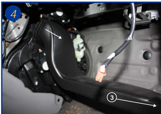
Retirer le conduit de ventilation en retirant le clips plastique situé au niveau du repère (3)
