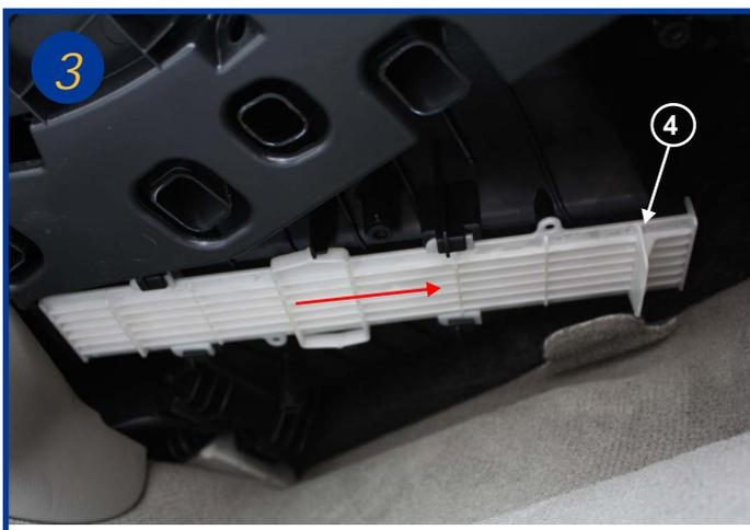
Ouvrir le boîtier de filtre en faisant coulisser son couvercle d'environ 3 cm dans le sens de la flèche à l'aide de la poignée (4).
