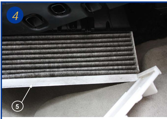
Sortir le filtre usagé à l'aide de sa languette prévue à cet effet (5) et le remplacer.
