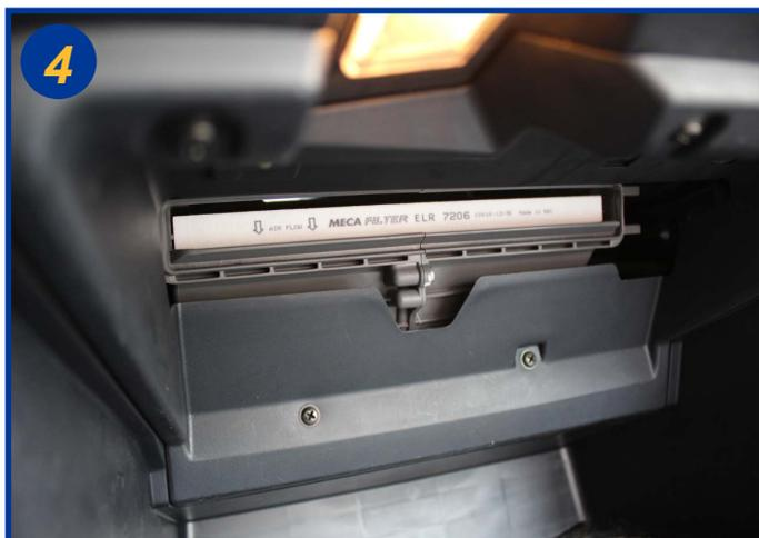
Retirer l'élément filtrant usagé et procéder à son remplacement.
