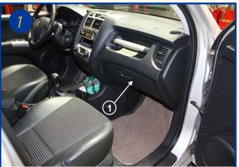
Le filtre d'habitacle est situé dans le véhicule, coté passager, derrière la boîte à gants (1).
