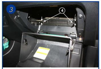
Basculer le tiroir de boîte à gants jusqu 'au plancher de l'habitacle. Appuyer sur les 2 fermoirs (4) pour libérer le tiroir du boîtier filtrant
