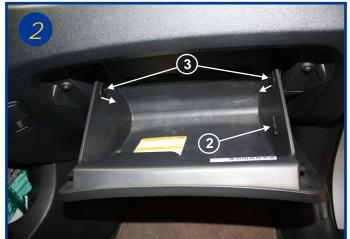
Ouvrir la boîte à gants, ôter l'arrêtoir (2) en tirant dessus et en le faisant ressortir par son trou, dégager ensuite les 2 butées (3) en soulevant les 2 supports plastiques.
