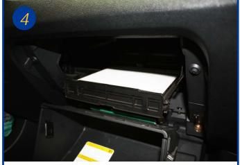
Sortir le tiroir et extraire le filtre usagé du cadre, le remplacer en imbriquant les premiers plis des 2 extrémités dans le nervures prévues à cet effet. Le remontage s'effectue dans l'ordre inverse du démontage.
