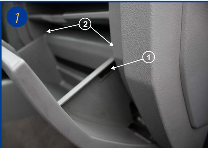
Le filtre d'habitacle est situé à l'intérieur du véhicule, côté passager derrière la boîte à gants. Ouvrir celle-ci et déconnecter l'élastique arrêtoir (1), puis appuyer sur les flancs pour dégager les butées (2).
