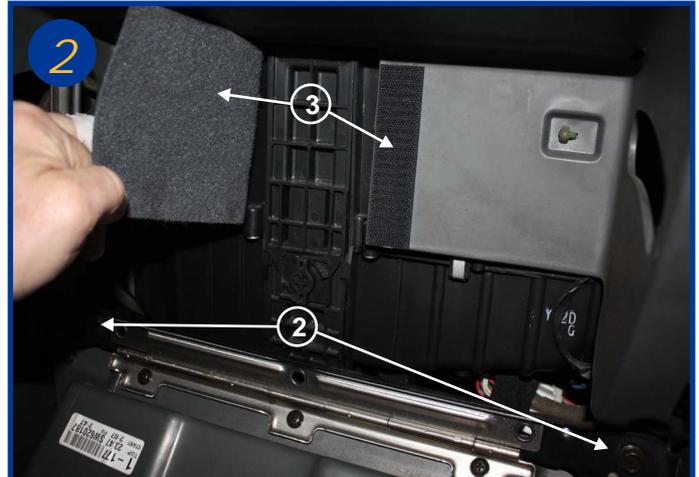
Dévisser les 2 vis de 10 de la traverse métallique et retirer le bloc tiroir de boîte à gants dans sa totalité (2). Le boîtier filtrant se trouve derrière une trappe souple fermé par un scratch (3).
