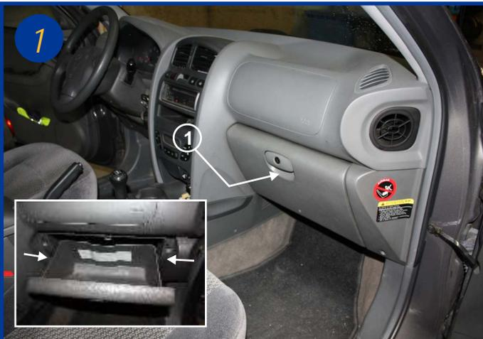
Le filtre d'habitacle est situé à l'intérieur du véhicule, côté passager derrière la boîte à gants (1). Ouvrir la boîte à gants, presser sur les flancs du tiroir (voir encadré) pour dégager les arrêtoirs et le basculer vers le bas.
