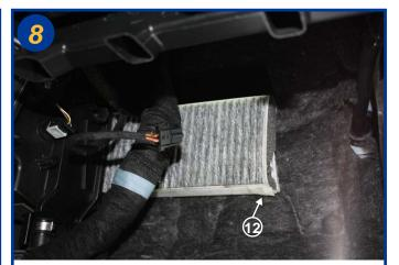
Extraire le premier élément en tirant sur la languette prévue à cet effet (12), l'autre se trouve positionné au dessus. Procéder à leur remplacement.
