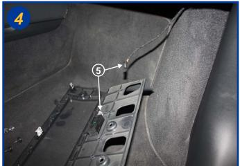
Avant de retirer le carter dans sa totalité, débrancher la lampe du plafonnier (5).
