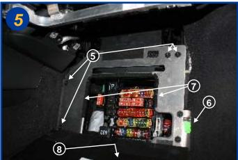
Déposer le cache du repose-pied, pour cela ouvrir la trappe puis dévisser les 4 vis Torx (T25)(5) et la vis hexagonale de 10 (6). Retirer le cache.
