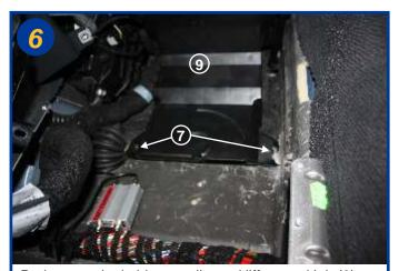
Retirer ensuite le bloc ventilateur/diffuseur d'air (9), débrancher la connectique du ventilateur.
