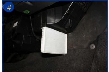
Remplacer I 'élément filtrant. Le remontage s' effectue dans I 'ordre inverse du démontage.
