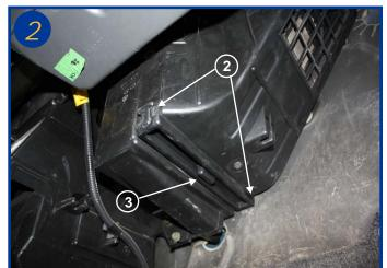
Actionner les deux fermetures en plastique du couvercle sur le boitier de l'élément filtrant (2) et tirer sur la poignée (3) pour retirer le couvercle.
