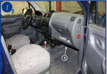
L'élément filtrant est situé dans l'habitacle du véhicule sous la boîte a gants coté passager (1).
