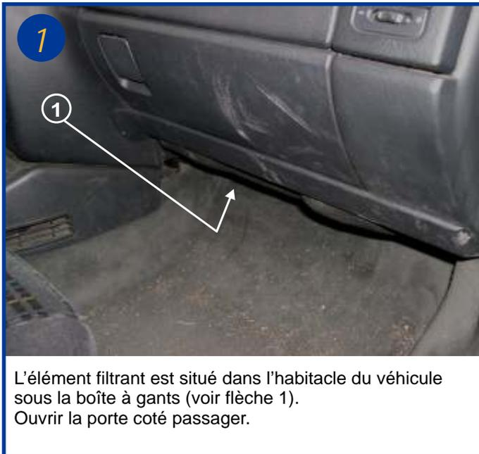
L'élément filtrant est situé dans l'habitacle du véhicule sous la boîte à gants (voir flèche 1). Ouvrir la porte coté passager.
