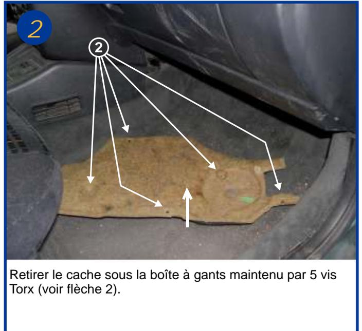
Retirer le cache sous la boîte à gants maintenu par 5 vis Torx (voir flèche 2).
