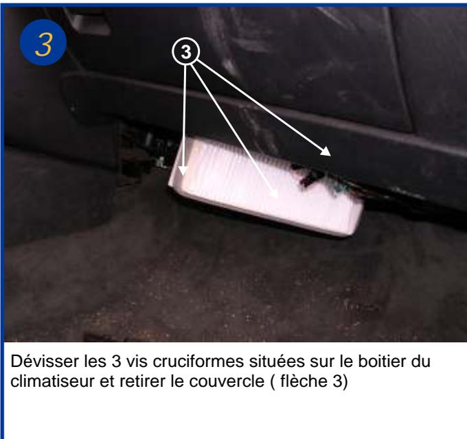
Dévisser les 3 vis cruciformes situées sur le boîtier du climatiseur et retirer le couvercle ( flèche 3)
