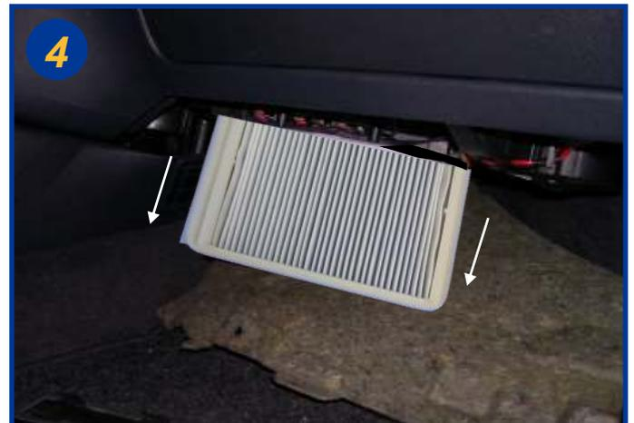
Extraire l'élément filtrant usagé en le tirant vers le bas. Le remontage s'effectue dans l'ordre inverse du démontage.
