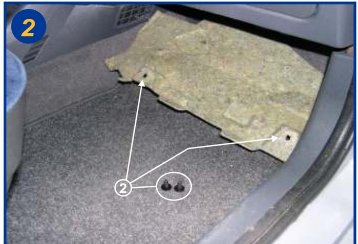
Retirer les 2 goupilles plastiques (2) et abaisser le cache sous la boîte à gants, il n'est pas nécessaire de le retirer totalement.
