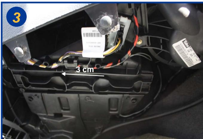
Faire coulisser d'environ 3 cm la trappe d'entrée du boîtier filtrant (voir flèche) et retirer le couvercle.
