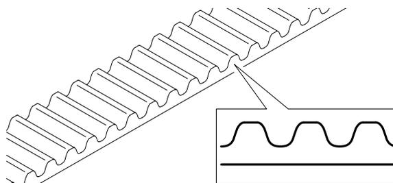
Image 6 : Courroie crantée à profil en développante (STD)
