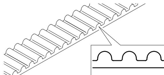
Image 5 : Courroie crantée à profil circulaire (HTD)
