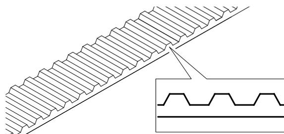
Image 4 : Courroie crantée à profil trapézoïdal
