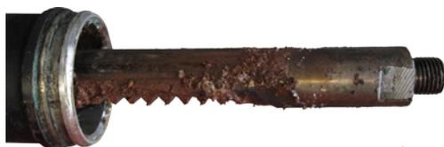
Ne pas utiliser de colliers de serrage ou attache-câbles normaux pour les joints-soufflets. Le joint-soufflet pourrait gondoler et de l'eau, ainsi que de la saleté pourrait y pénétrer.
