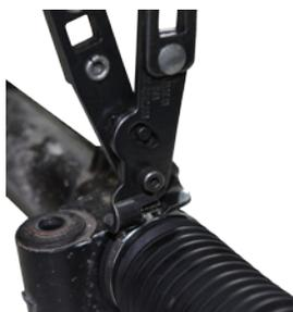
En fonction du type de bride de fixation utilisé, il est impératif d'utiliser la pince spéciale correspondante !
