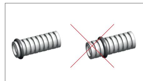
3. Den Clip für den eigentlichen Wellrohrverbinder (bzw. Adapter für den Glattschlauch) bitte in die nächste Rille hinter dem Dichtring einsetzen und um das Wellrohr legen. Danach das Rohr in den Verbinder einschieben und verrasten. Achtung: Das Wellrohr muss sich mit einem leichten Widerstand einführen lassen. Bei einem zu leichten oder zu schweren Einführen wurde der falsche Dichtring gewählt.
