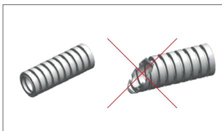
3. Installer le clip du raccord de tube ondulé (ou de l'adaptateur pour tube lisse) dans la rainure suivante, derrière le joint torique et le positionner autour du tube ondulé. Insérer ensuite le tube dans le raccord et verrouiller. Attention : une légère résistance doit être ressentie à l'insertion du tube ondulé. Si l'insertion est trop facile ou trop difficile, cela signifie que la bague d'étanchéité choisie ne convient pas.
