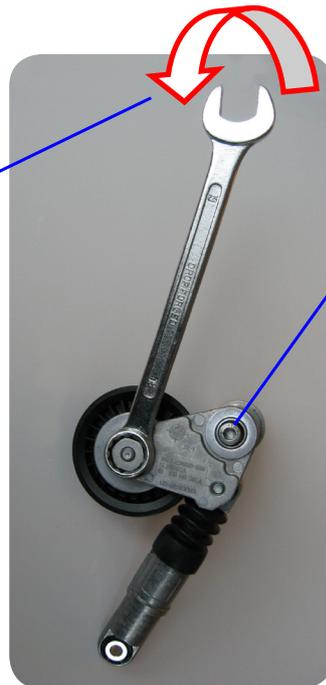
Le couple de serrage (support à vis) est de **25 Nm**.
