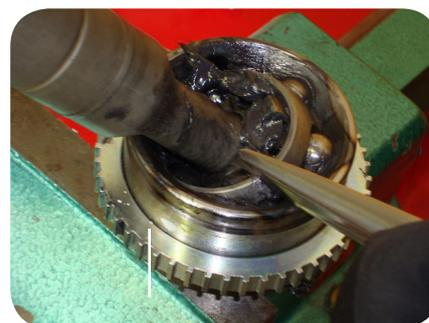
3. Placer le joint homocinétique dans l'étau. Briser la cage à plusieurs endroits, le long du bord (près des billes), à l'aide d'un marteau et d'un burin.
