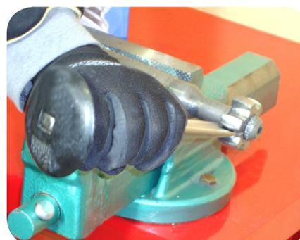
6. Élargir et déposer le circlips à l'aide d'une pince de dépose de circlips.
