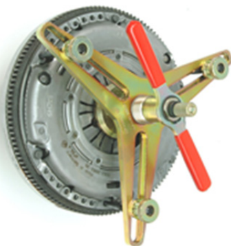
Fig. 3 : Dispositif de serrage avec mandrin de centrage
