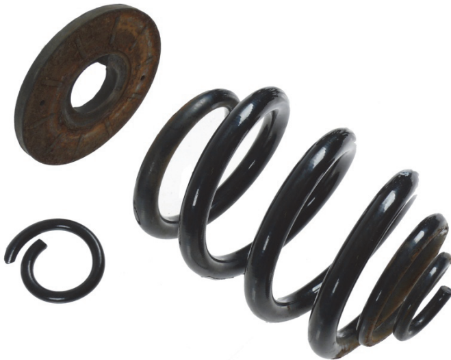
Fig.1: Cuvette de ressort usée et ressort de châssis brisé
