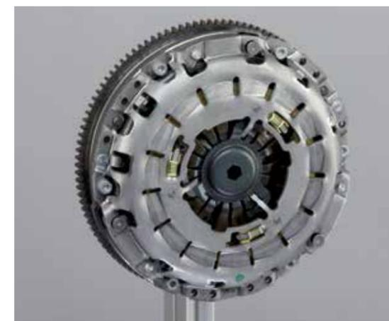
Les mécanismes d'embrayage pour certains modèles de BMW sont livrés avec un dispositif de verrouillage. Ce dispositif de verrouillage empêche cependant l'utilisation d'un centreur conventionnel de sorte qu'il faut utiliser un centreur spécial ou une douille de centrage.
