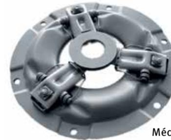
Mécanisme d'un ancien embrayage à diaphragme
