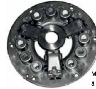
Mécanisme d'un embrayage à ressorts hélicoïdaux
