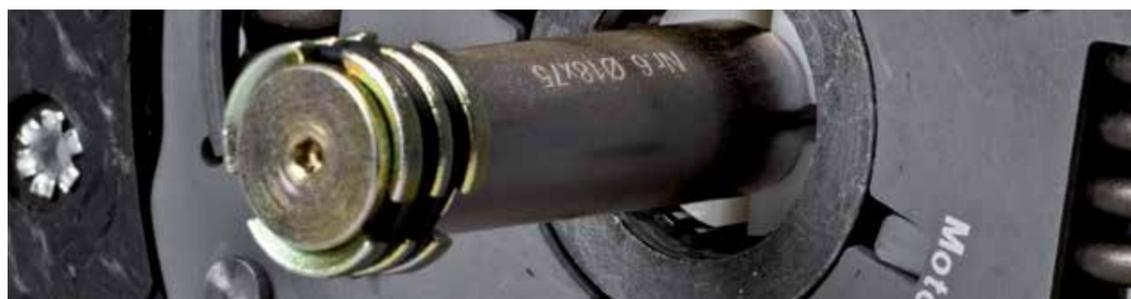
La configuration du centreur dépendra d'une part du diamètre intérieur de la douille de guidage ou de l'alésage du vilebrequin et d'autre part de la distance entre la douille de guidage ou l'alésage du vilebrequin et la cannelure du moyeu du disque d'embrayage.
