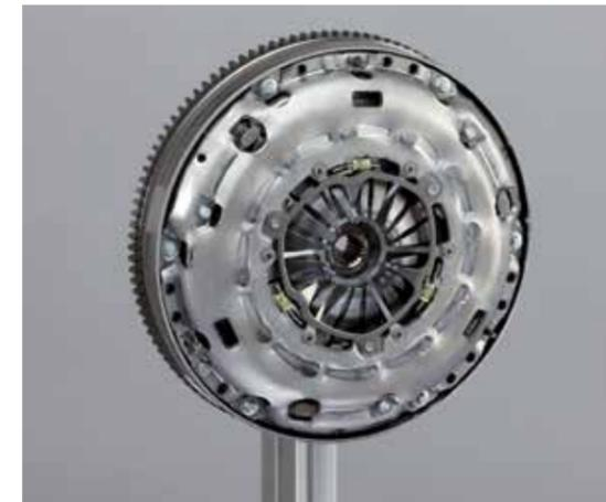
Si la réparation nécessite de démonter le SAC pour ensuite le réutiliser, il est impératif que la dépose soit faite avec l'outillage spécial. En effet, une fois remonté, le SAC ne fonctionnera parfaitement que s'il avait été correctement déposé.
