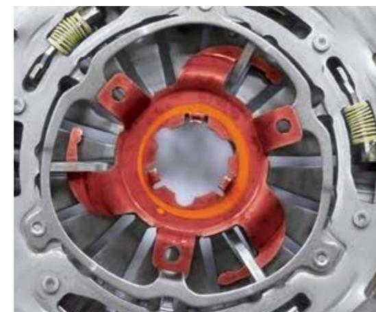
Certains mécanismes d'embrayage destinés aux véhicules des marques mentionnées ci-dessus peuvent être livrés avec un dispositif de verrouillage. Le centrage du disque d'embrayage se fait avec le centreur universel.
