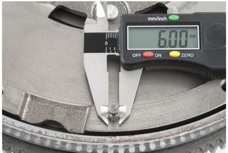
Photo 1 : Mesure du diamètre du téton de centrage
