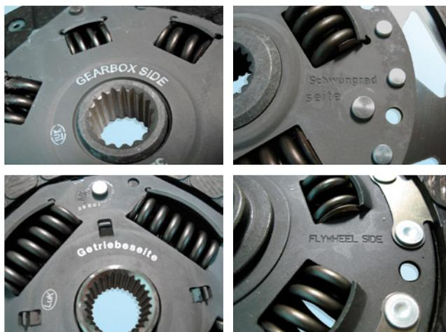
Bild 1-4: mögliche Beschriftungen auf der Kupplungsscheibe
