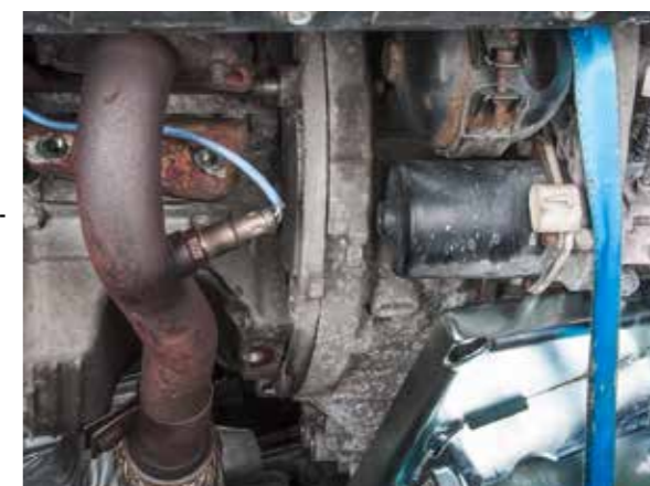
Rapprocher autant que possible la boîte de vitesses du moteur.
