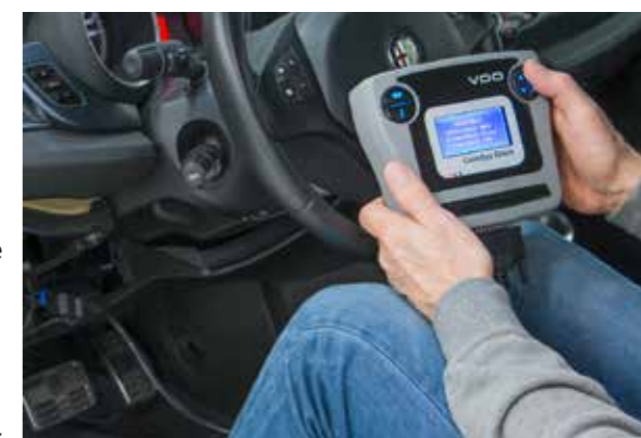
Réglage de base avec l'appareil de diagnostic approprié
