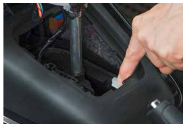
Un bouton de pression permet de déverrouiller le levier de vitesses
