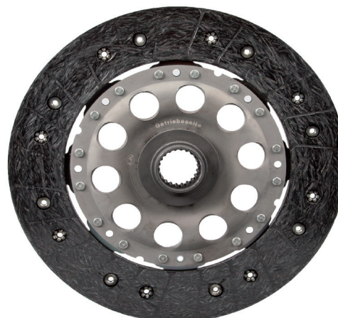
Photo 2 : Disque d'embrayage première monte (diamètre 240mm)
