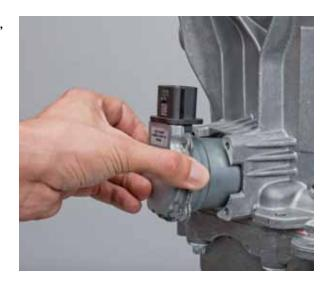
• Serrer les nouvelles vis sur le socle des actuateurs avec un couple de 19 Nm.
