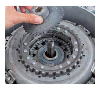
Enlever la bague de sécurité de l'arbre creux avec la pince de sécurité (KL-0192-12); en règle générale, la bague s'abîme lors de cette manœuvre et doit être remplacée.
