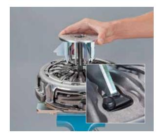
Dans un premier temps, ne serrer l'écrou de la broche que jusqu'à ce qu'elle entre en contact avec la pièce de pression.
