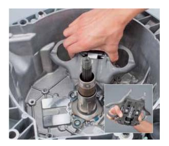
Introduire le nouvel actuateur de levier pour K1 (ouverture large de la fourchette). La douille et le goujon d'ajustage en définissent le bon positionnement.
