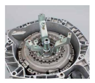
• Introduire la pièce d'arrêt (KL-0500-8210) avec l'orifice central sur la douille d'appui et fixer les crochets
