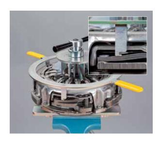
Tourner la bague de réinitialisation dans le sens inverse des aiguilles d'une montre (direction de la flèche sur la bague) jusqu'à la butée
