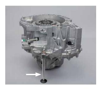
• Enlever la bague de sécurité du moyeu du disque d'embrayage supérieur (K1) avec un tournevis
