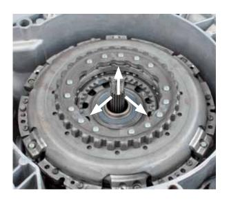
Poser le poussoir magnétique du crochet sur l'embrayage
