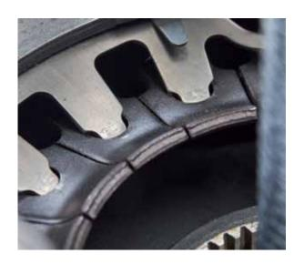
• Poser la bague de pression Ø 85 mm (KL-0500-7110) sur le diaphragme de K1
