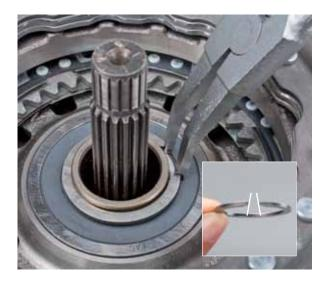
Monter le moyeu du disque d'embrayage supérieur (K1).
