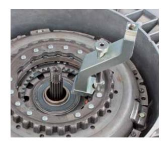
• Appuyer sur le crochet pour l'introduire dans le carter de l'embrayage
