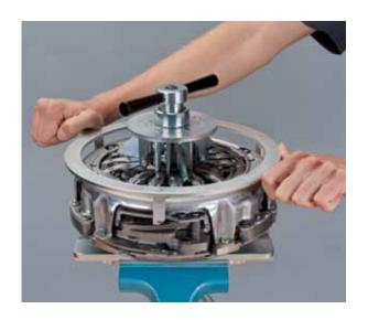
Maintenir la bague de réinitialisation dans cette position avec une main et serrer l'écrou de pression avec l'autre jusqu'à la butée.
