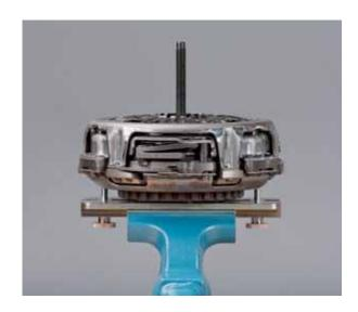
• Introduire les goujons de fixation dans la denture du volant bimasse et serrer les vis moletées.
