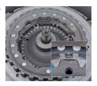
Mettre en place la bague de sécurité de sorte que la jointure de la bague soit centrée par rapport à la languette
