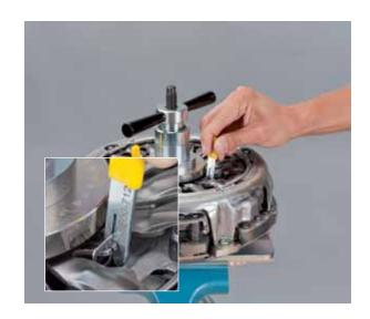
• Desserrer complètement l'écrou de pression (les pièces de fixation tombent)
