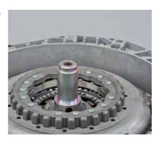
Monter trois boulons filetés (KL-0500-6021 ou KL-0500-6022) sur le carter de la boîte de vitesses avec des écrous à embase.
