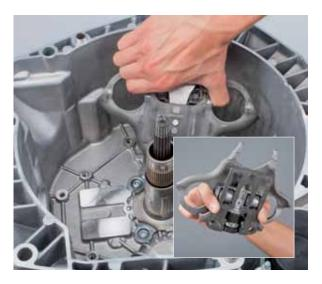
• Démonter les trois vis de la douille de guidage
