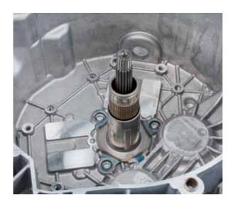
Introduire le nouvel actuateur de levier pour K2 (ouverture étroite de la fourchette). La douille et le goujon d'ajustage en définissent le bon positionnement.
