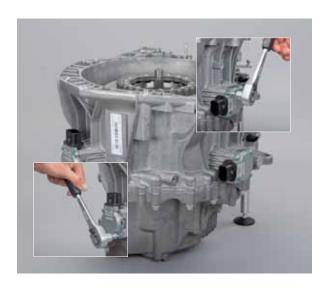
• Introduire la clé de déverrouillage (KL-0500-8011) avec le marquage (sur la surface striée) vers le haut dans l'actuateur de levier pour K2.
