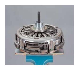
Dans un premier temps, ne serrer l'écrou de pression de la broche que jusqu'à ce qu'elle entre en contact avec l'adaptateur
