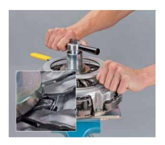
Accrocher les languettes de la sécurité de transport K1 à l'aide des pièces de fixation
