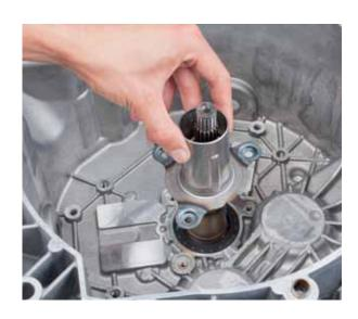
Nettoyer l'arbre d'entrée de boîte avec un produit sans solvant et veiller à ce qu'il reste un peu de graisse dans la denture.
