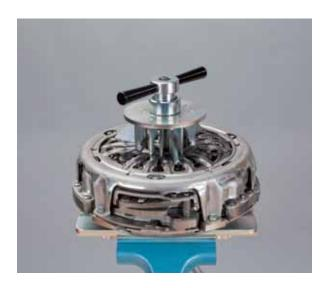
Poser la grande bague de réinitialisation pour K2 (KL-0500-714) sur le double embrayage et l'insérer dans les languettes de l'anneau de réglage
