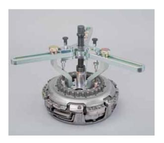
Poser le nouvel embrayage sur l'arbre creux; une légère rotation permet la bonne imbrication des dentures du disque d'embrayage K2 et de l'arbre creux.
