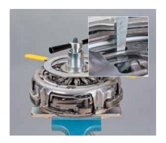
Tourner la bague de réinitialisation dans le sens des aiguilles d'une montre (direction de la flèche) jusqu'à la butée
