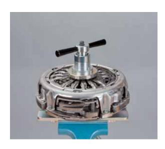
Introduire la petite bague de réinitialisation pour K1 (KL-0500-715) dans les 3 fentes de la rampe de compensation pour K1
