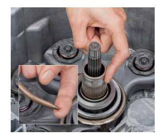
Préparer l'embrayage pour la pose. Pour ce faire, monter l'outillage spécial comme pour la dépose du double embrayage
