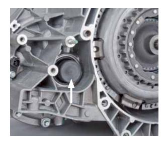
Fixer la boîte de vitesses sur un dispositif de montage ou la poser sur un établi en la sécurisant avec le support (KL-0500.802) de sorte que la cloche d'embrayage soit positionnée à l'horizontale.
