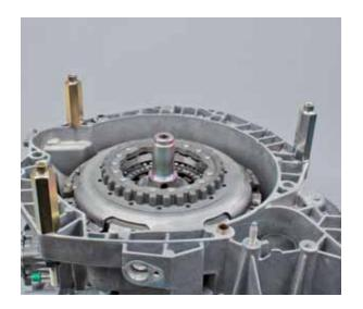
Monter sans forcer le support de broche à 3 branches (KL-0500-60) avec les vis moletées (KL-0500-6020) sur les boulons filetés.
