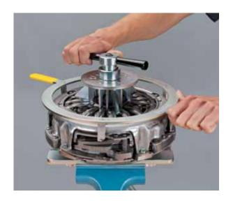
• Démonter l'écrou de serrage, la pièce de pression et la bague de réinitialisation
