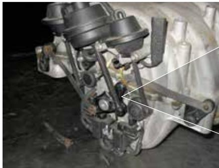
*Constataion des dégâts : rupture au niveau de la tringlerie de commande des vitesses*
