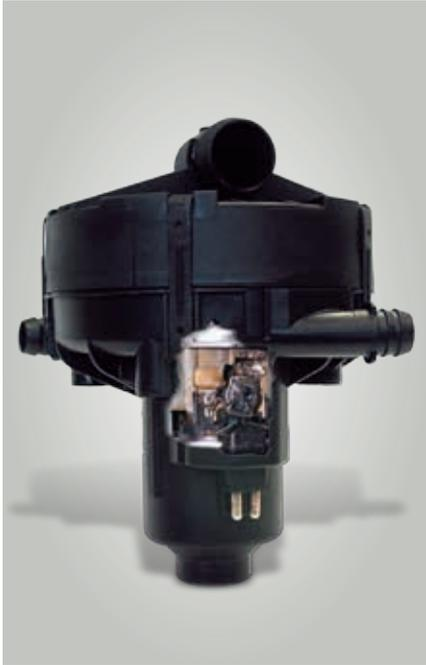
Vue de l'intérieur de la pompe à air secondaire (en coupe) avec des traces de fusion
