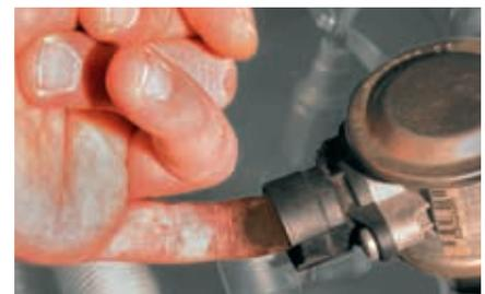
Essai au doigt au niveau de la valve d'air secondaire sur BMW 520i (en rouge) Si des dépôts sont présents de ce côté, le clapet anti-retour n'est pas étanche et doit être remplacé.
