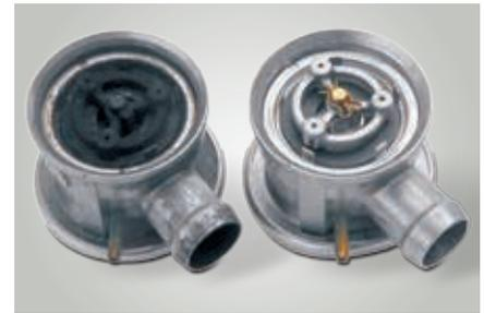
Valve d'air secondaire ouverte, à gauche : dommages causés par du condensat de gaz d'échappement, à droite : état neuf
