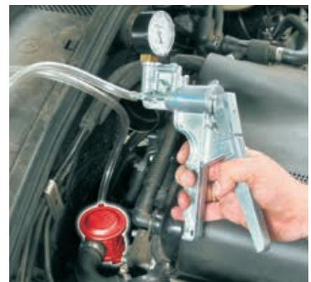
Contrôle d'une valve d'air secondaire avec une pompe à vide manuelle
