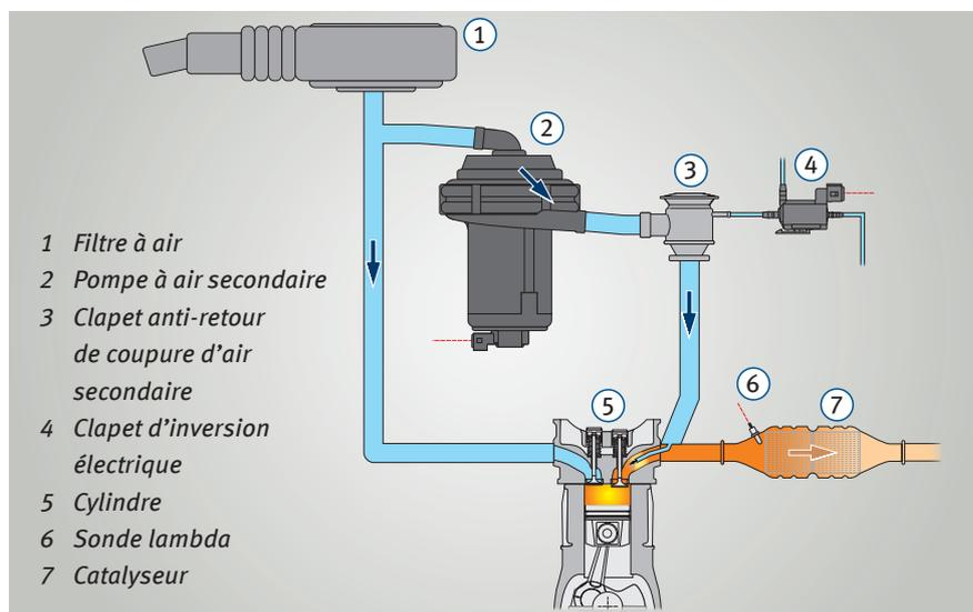
Principe de l'injection d'air secondaire (à commande pneumatique)
