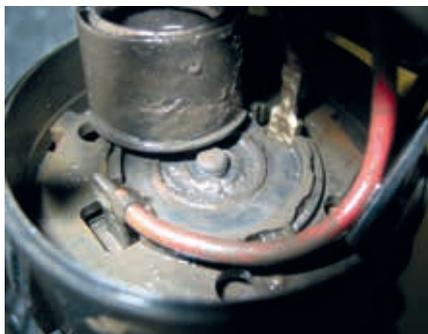
Présence de condensat de gaz d'échappement agressif dans le moteur d'entraînement d'une pompe à air secondaire
