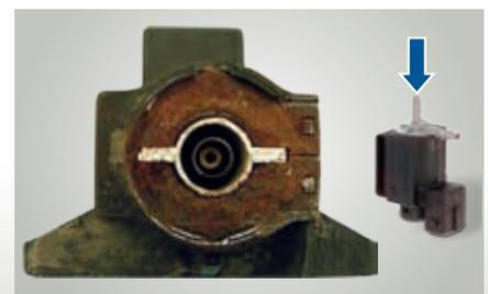
Clapet d'inversion électrique corrodé (ouvert)
