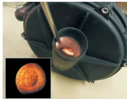
Vue de l'entrée corrodée d'une pompe à air secondaire
