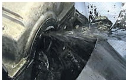
Attention : si l'alimentation en huile lubrifiante est irréprochable, 30 à 60 litres par heure peuvent s'écouler.
