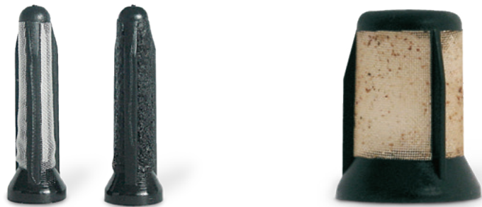
Préfiltre de la E1F : neuf à gauche, obstrué à droite
