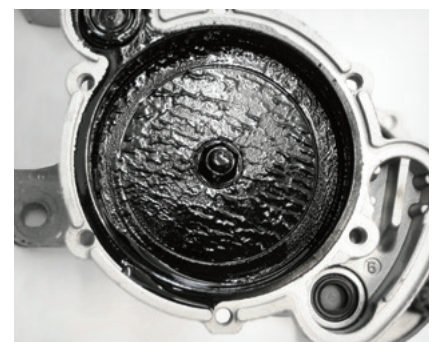
Fig. 3 : Boue d'huile dans la pompe à vide du VW Transporter à l'origine de claquements
