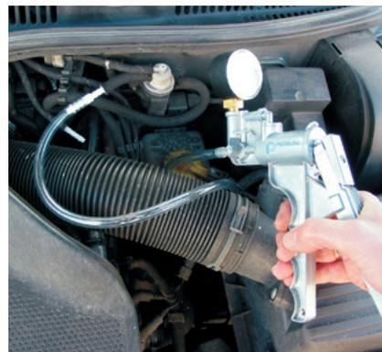
Qu'il s'agisse de vannes EGR pneumatiques ou, comme ici, d'un convertisseur de pression : le fonctionnement est facilement contrôlable à l'aide d'une pompe à vide manuelle.
