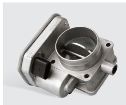
Vu que sur les véhicules diesel, la différence de pression entre le côté échappement et le côté aspiration est insuffisante pour les taux de recyclage des gaz d'échappement élevés, des « volets d'air » sont installés dans le collecteur d'admission pour produire la dépression nécessaire.
