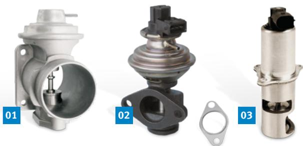
Les vannes EGR des véhicules diesel présentent des diamètres d'ouverture importants en raison des taux de recyclage élevés.
