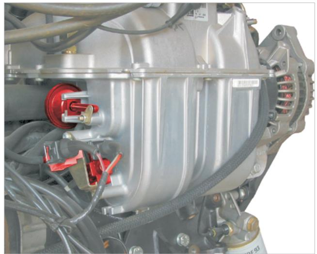
La tubulure d'aspiration à résonance de l'Opel Astra ne comporte pas moins de deux vannes d'inversion (signalées en rouge). L'une commande les clapets de tubulure d'aspiration via la capsule sous pression (signalée en rouge) qui la coiffe ; l'autre actionne la soupape de fermeture d'air secondaire (non reproduite).
