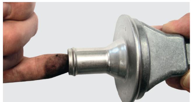
Figure 1: Simple contrôle du clapet anti-retour
