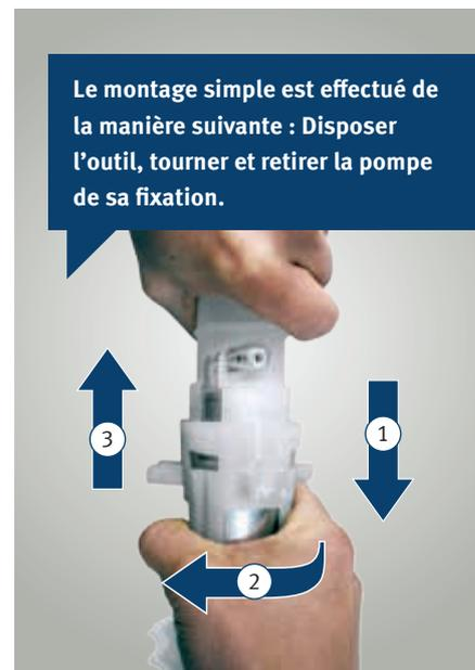
Le montage simple est effectué de la manière suivante : Disposer l'outil, tourner et retirer la pompe de sa fixation.
