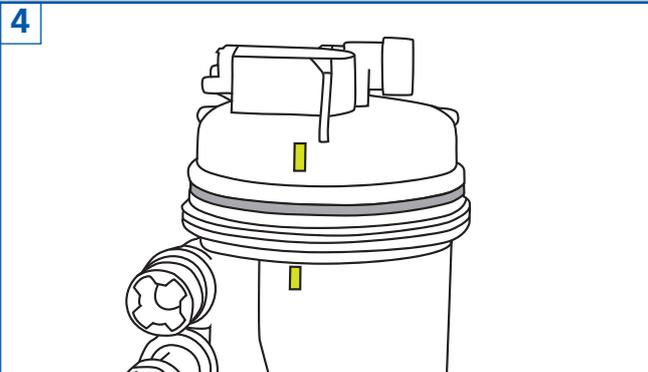
Ersetzen Sie die Gummidichtung zwischen den beiden Teilen des Gehäuses durch die mit dem neuen Filter mitgelieferte Dichtung. Bringen Sie den oberen Teil am Gehäuse an, indem Sie die gelben/grünen Markierungen aufeinander ausrichten.
