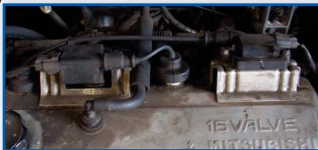
Blue Print recommande vivement de remplacer les bougies d'allumage et les câbles HT en plus de l'ensemble de bobine, ou de les contrôler soigneusement. Nous recommandons également de suivre une procédure de diagnostic logique (avant de remplacer la bobine d'allumage) afin d'éviter un remplacement inutile.
