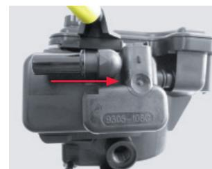
Pour le démontage : appuyer vers le bas sur le côté gauche de la zone de clip inférieure et pousser vers l'avant le bord inférieur du préchauffeur. Ensuite, éloigner le préchauffeur du point de jonction préchauffeur/filtre en le poussant dans le sens inverse de la direction de montage.
