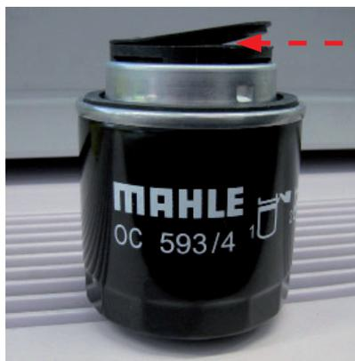
*Joint du mécanisme anti-retour, légèrement surélevé par rapport à l'organe de retenue pour l'exemple*
