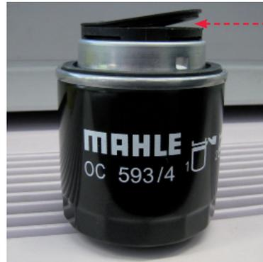
*Dichtung der Leerlaufmechanik, zur Veranschaulichung leicht aus der Aufnahme angehoben*
