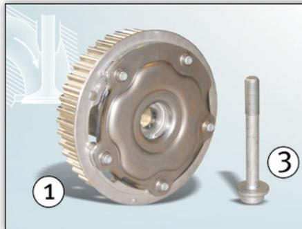
**Image 1 :** Déphaseur d'arbre à cames du côté admission, référence 427 1004 10, et vis centrale 41301\*
